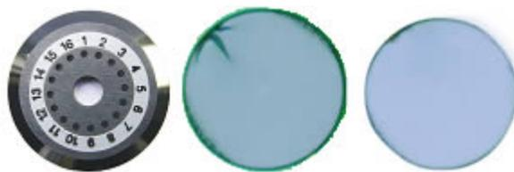
Рисунок 1: Лезвие скальвателя (слева) и фото сколов произведенных обычным скальвателем (по центру) и с применением системы масляного демпфирования (справа).
