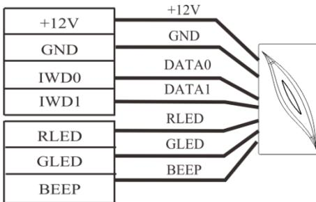
В устройстве есть функция Wiegand входного сигнала (ин). Речь про возможное подключение к независимому карт ридеру. Устанавливаются на каждой стороне двери, чтобы контролировать замок/доступ вместе.
