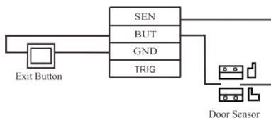
Door sensor/Exit button – Дверной сенсор/Кнопка выхода
