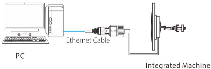
Соедините RJ45 порт интегрированного устройства к Ethernet порту ПК.
