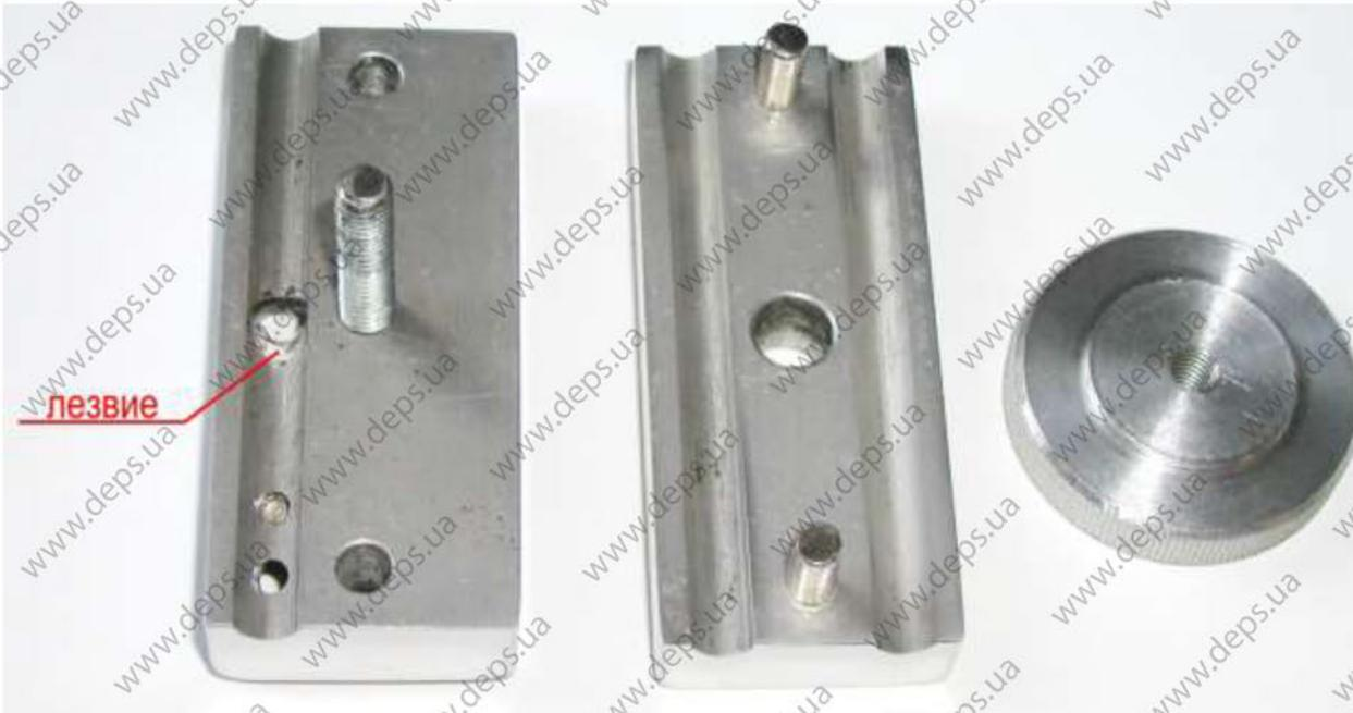
2. С помощью шестигранного ключа 3мм нужно ослабить крепление лезвия. Затем немного сдвинуть его в нужном направлении, при этом не рекомендуется прикасаться к кромке лезвия металлическими предметами. Затяните болт крепления плотно, но без чрезмерных усилий во избежание повреждения резьбы.
